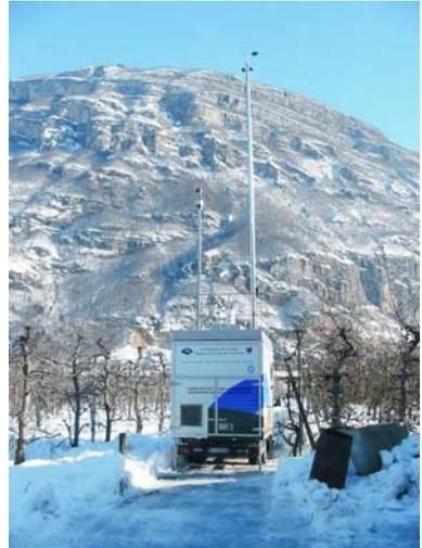
**Abb. 16** Eine mobile Luftqualitätsmessstation der Landesagentur für Umwelt der Autonomen Provinz Bozen.
