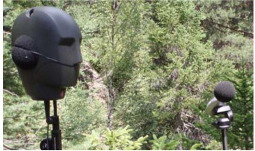
**Abb. 17** Ein binaurales Kopfmikrofon (links) und ein monaurales Mikrofon (rechts) registrieren den Verkehrslärm in einem Erholungsgebiet im Maurienne-Tal (F). Beide Sensoren sind mit Schaumstoff gegen Windgeräusche geschützt.
