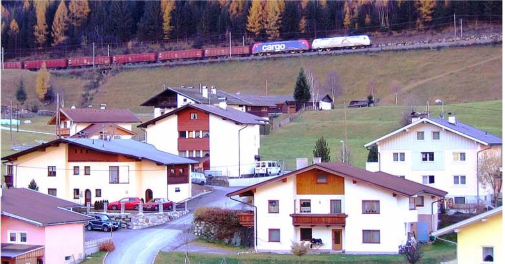
**Abb. 4** Drei elektrische Lokomotiven, zwei ziehend und eine schiebend, sind notwendig um die rumpelnden Waggonen dieses schweren Güterzuges über die Steilstrecke nahe des Ortes St. Jodok/Tirol in Richtung Brenner zu bewegen.
