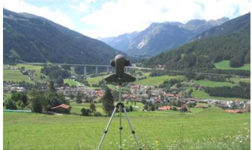
**Abb. 13** Ein Kunstkopfmikrofon zeichnet den „Amphitheaterereffekt“ an der Ostseite des Wipptals (bei Steinach/Österreich) auf. Im Hintergrund ist eine Brücke der Brennerautobahn erkennbar.
